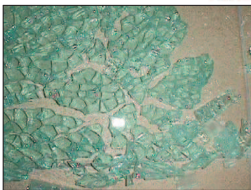
Modalità di rottura - Vetro Temprato
